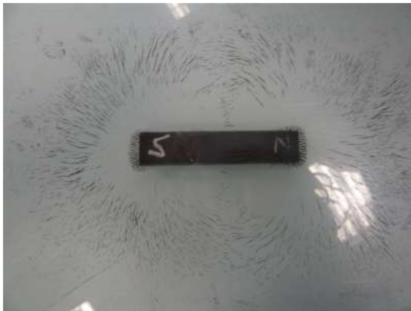
Illustration 15 : la limaille de fer se répartit autour de l'aimant selon le champ magnétique.
