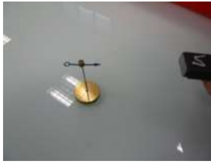
Illustration 5 : aiguille attirée par l'aimant.
